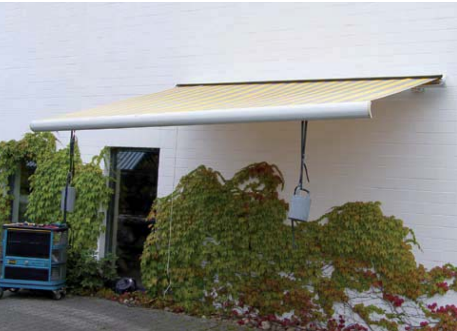
Belastungstest nach Windklasse 2 und DIN EN 13561 / DIN1932.
