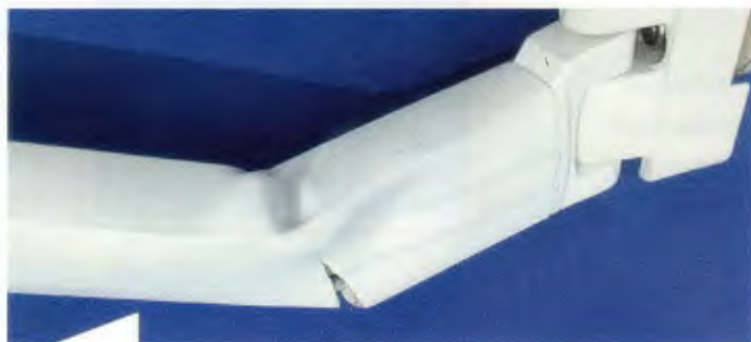
Gleichzeitige Verformung des rechten Markisenarms beim Bruch auf der linken Seite.
