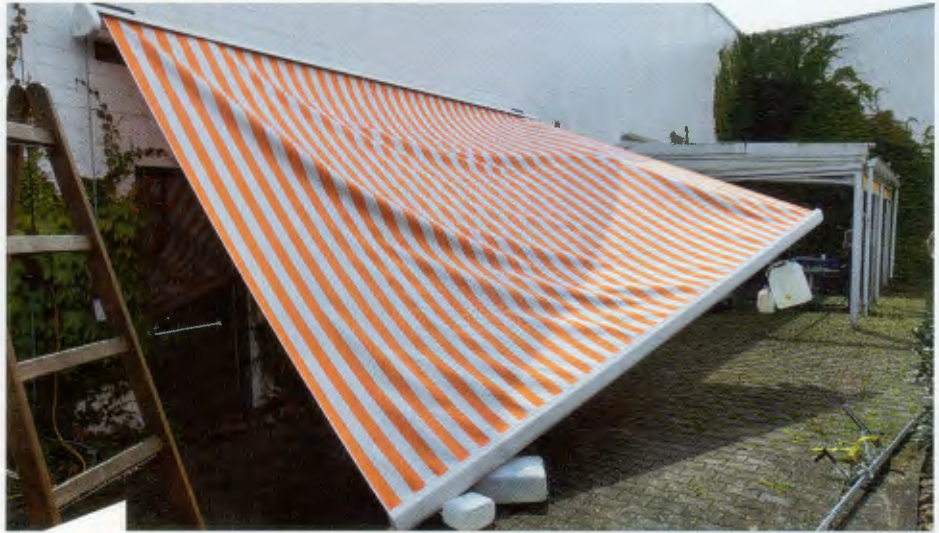
„Absenken“ der Markise durch Bruch des linken Oberarmgelenks. Mehr Bilder vom Markisentest können Sie online abrufen: Geben Sie einfach auf www.glaswelt.de im Suchfeld den Webcode T126 ein.
